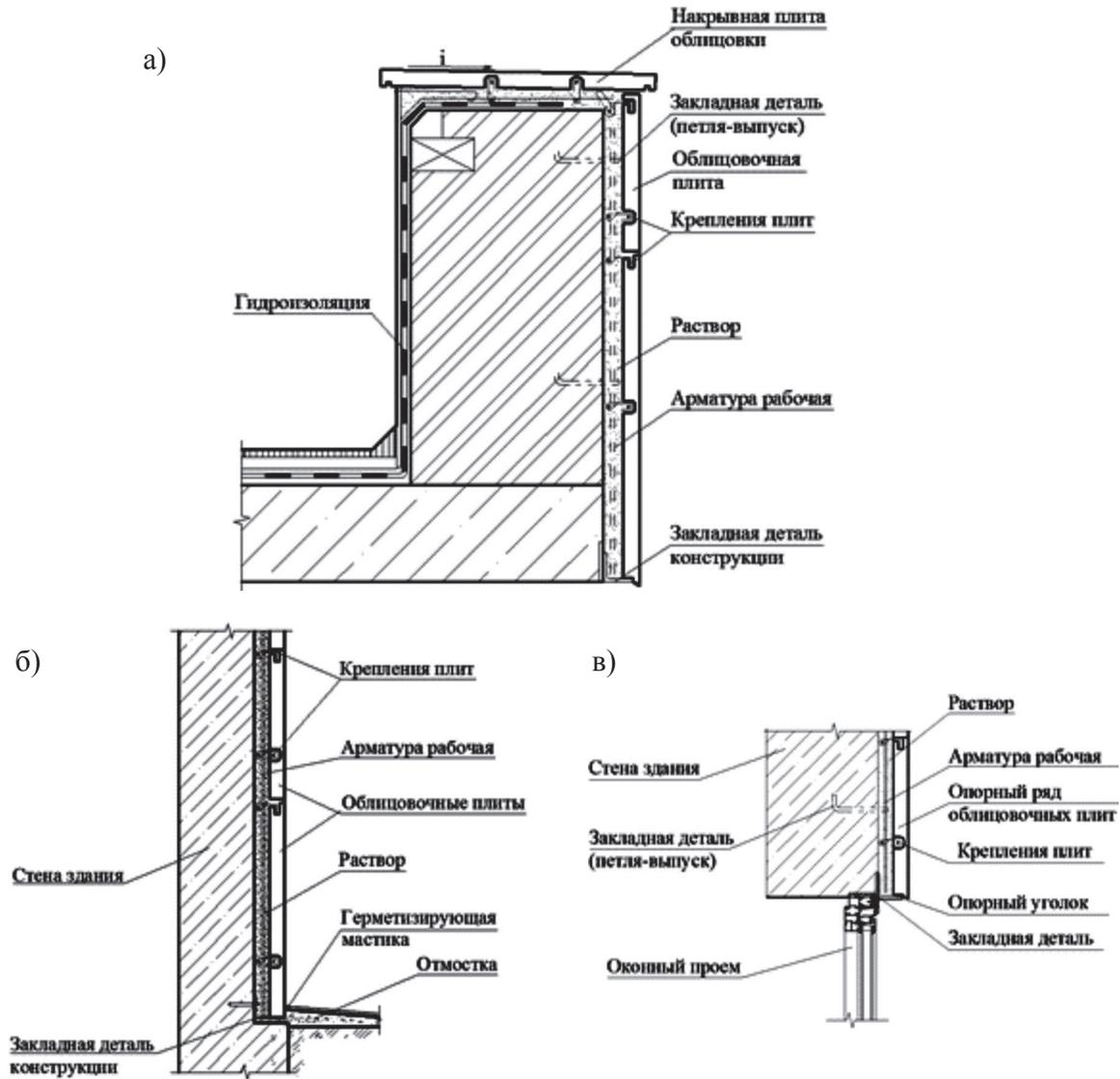
а) вариант устройства облицовочного слоя парапета (тип 3);
