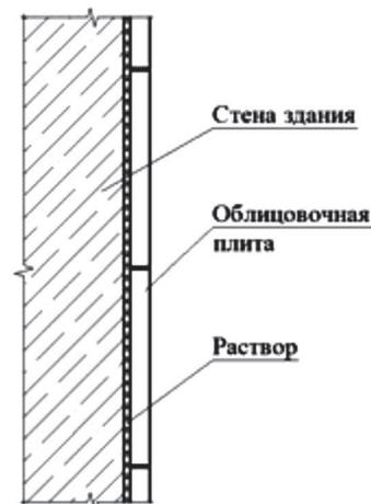
Рисунок 4 – Схема устройства облицовочного слоя тип 4 (рядовой участок)
