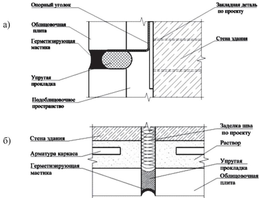
а) схема устройства горизонтального деформационного шва в облицовочном слое (тип 1, тип 2);
