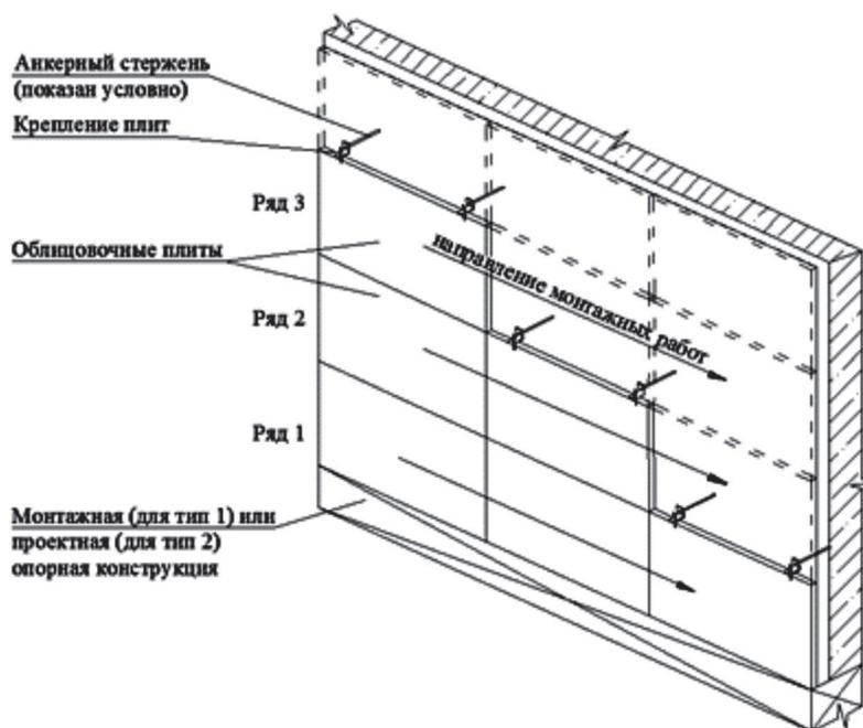
Рисунок 9.2 – Схема крепления плит облицовочного слоя (тип 1 и тип 2)
