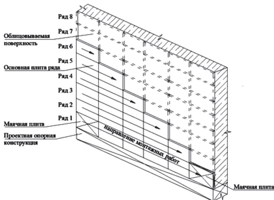
Рисунок 14 – Порядок монтажа облицовочной плитки (тип 4)
