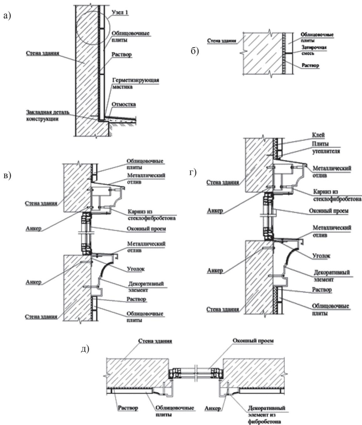
а) вариант устройства облицовочного слоя цоколя (тип 4);
