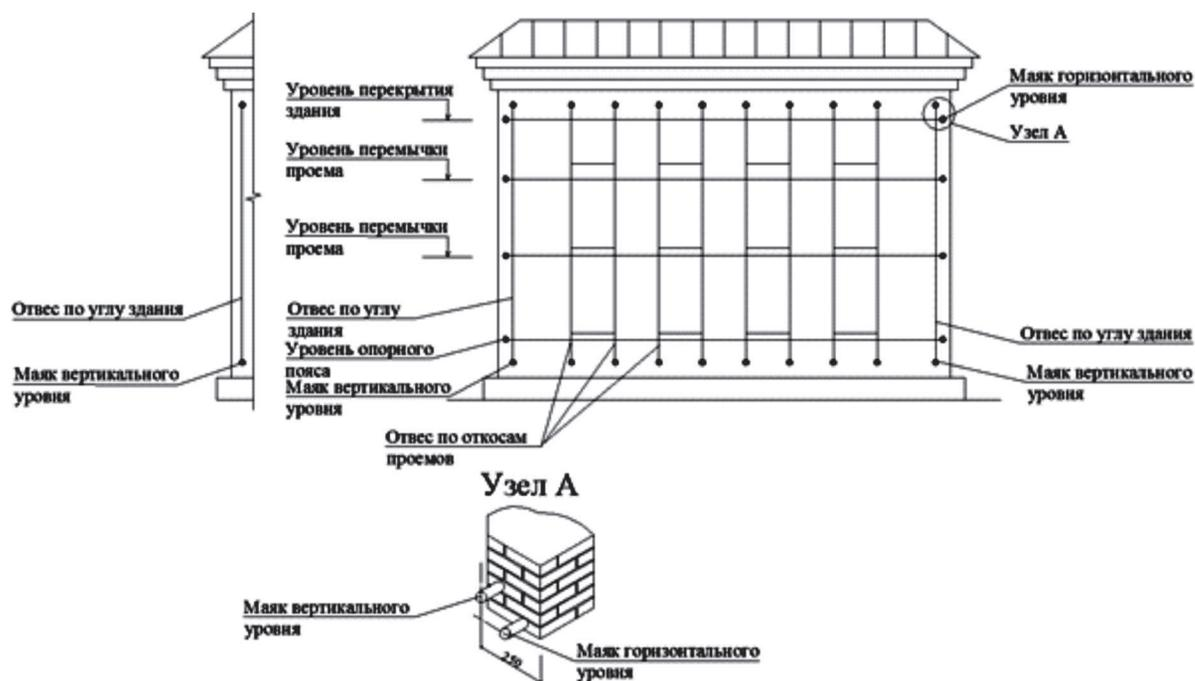
Рисунок 7 – Схема расположения отвесов и горизонтальных шнуров
