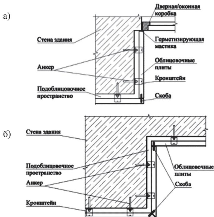
а) вариант крепления плит на углах здания и примыкание к дверным/оконным коробкам;
