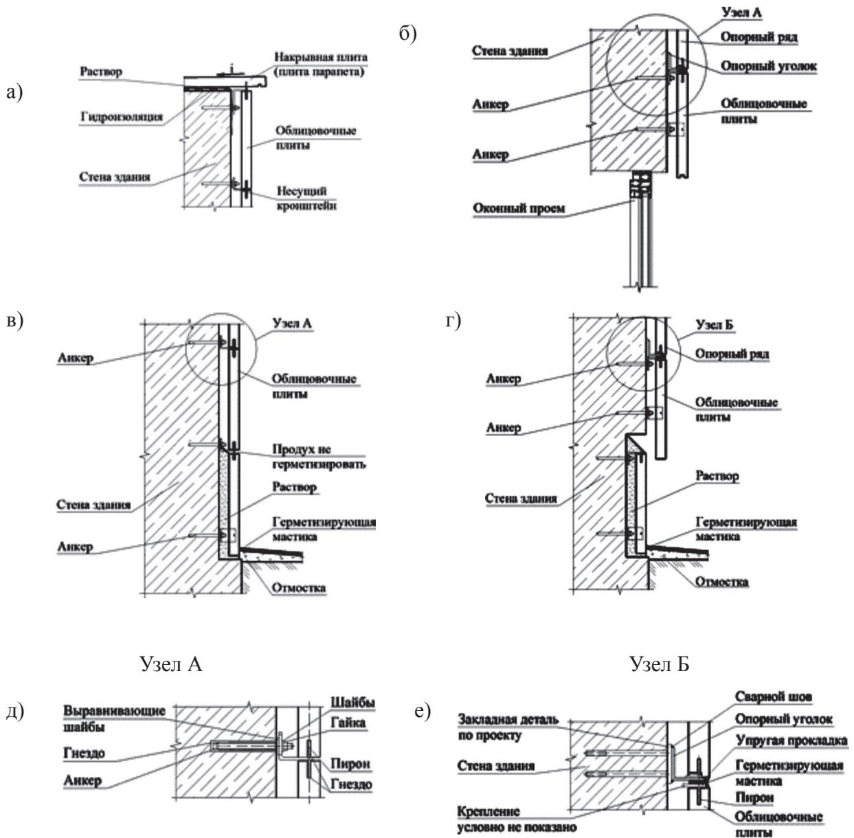
а) вариант устройства облицовочного слоя парапета (тип 1, тип 2); б) вариант устройства примыкания облицовочного слоя к откосу проема (тип 1, тип 2); в) вариант устройства облицовочного слоя цоколя (тип 1); г) вариант устройства облицовочного слоя цоколя (тип 2); д) узел крепления опорного кронштейна (тип 1); е) узел крепления опорного кронштейна (тип 2)
