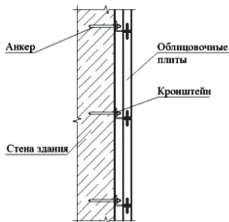
Рисунок 1 – Схема устройства облицовочного слоя (тип 1)
