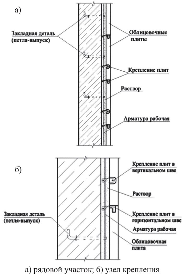
Рисунок 3 – Схема устройства облицовочного слоя (тип 3)
