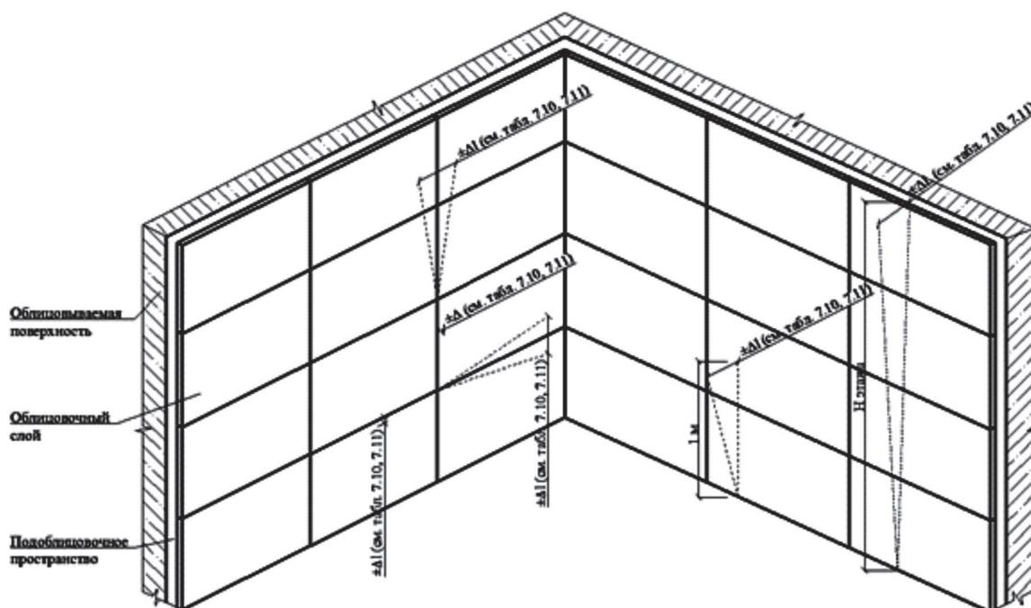
Рисунок 15 – Контролируемые параметры выполненной конструкции облицовочного слоя
